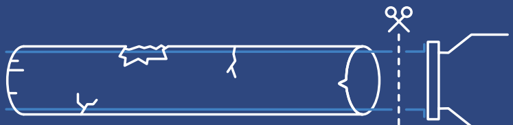
Fig.4 - Etter innblåsning herdes epoxyen med varmluft. Deretter kappes røret oppe og nede. Det er dette som utgjør den nye rørstammen, en fullverdig konstruksjon inne i det gamle røret
